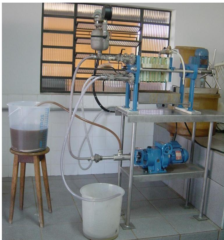
**Figura 4.** Filtro prensa disponível no CENA para filtração de metais pesados precipitados
