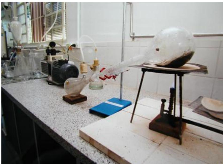
**Figura 1.** Sistema de destilação para recuperação de Hg proveniente de resíduos de amálgama dental (Pécora, 1998).
