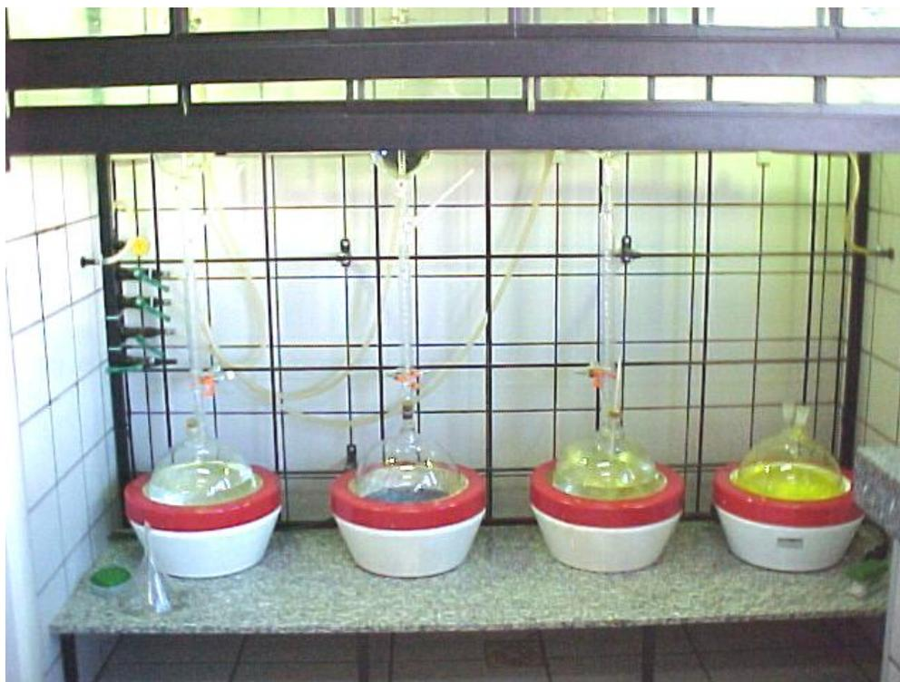
**Figura 2.** Sistemas de destilação de xilol contendo manta aquecedora, balão e coluna de vigreux (Fonte: Alberguini & Rezende, LRQ/HU/IQSC-USP).
