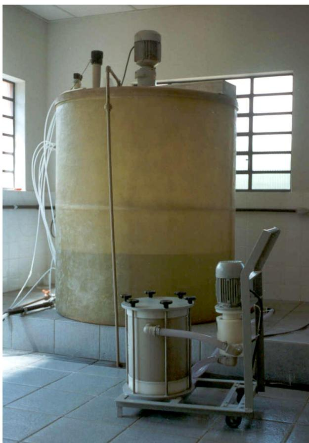
**Figura 7.** Reator de fibra de vidro com capacidade para 2000 litros (recuperação de efluentes amoniacaís).
